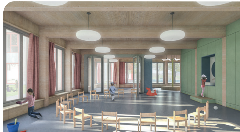
Im Innenraum des Kindergartens wird mehrheitlich Holz als Baumaterial verwendet. Als Bodenmaterial wird ein weiches Linoleum eingesetzt.
